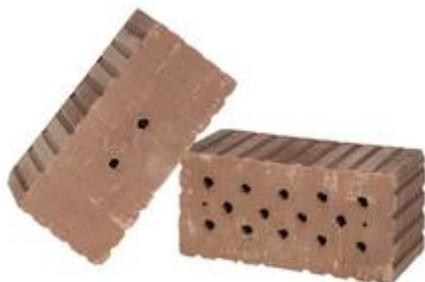
Die neuen Lehmsteine von Mein Ziegelhaus werden in unterschiedlichen Größen und Formen im Strangpressverfahren hergestellt. Sie entsprechen der Druckfestigkeitsklasse 2 nach DIN 18945 und Sie können sowohl für Innen- als auch Außenwände mit tragender oder nichttragender Funktion eingesetzt werden. Bild: tdx/Mein Ziegelhaus/Gerd Schaller
